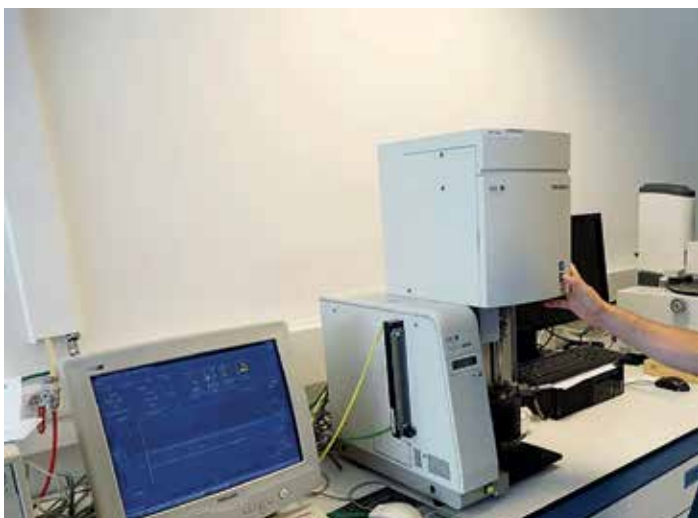
Analisi termico meccanica nel laboratorio (Gruppo Etex, Tisselt – Belgio)
