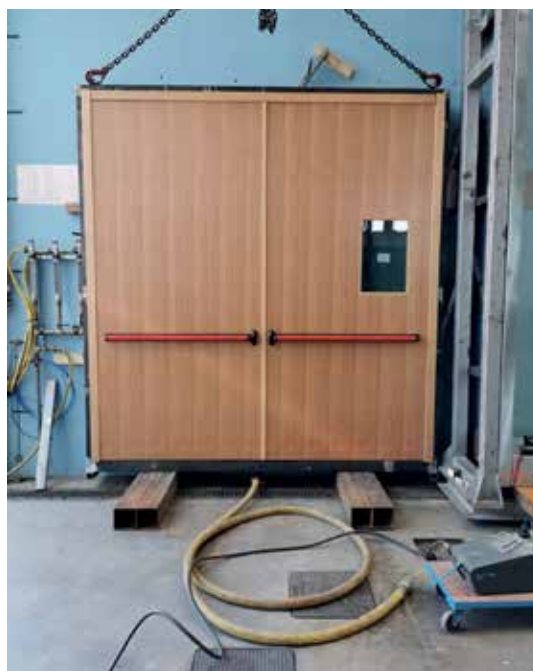
Porta in legno tagliafuoco sottoposta a test aria, acqua, vento (fonte Sebino Chiusure)
